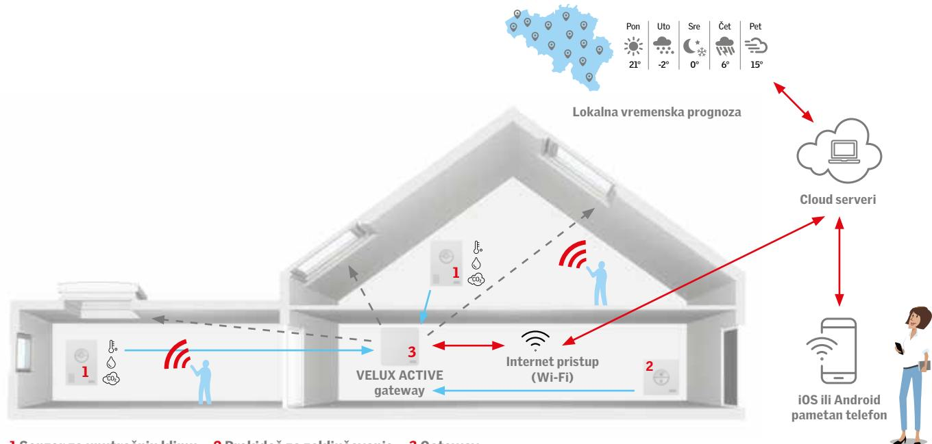
1 Senzor za unutrašnju klimu    2 Prekidač za zaključavanje    3 Gateway
